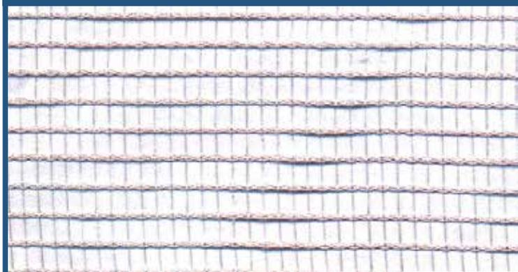
Ombra 12%. Maglia 4x7 mm. Rete in polietilene ad alta densità, tessute a giro inglese a due fili longitudinali con struttura compatta. Dotate di cimose rinforzate sui bordi laterali e al centro, per assicurare robustezza e resistenza nelle zone dove più forti sono le sollecitazioni strutturali. Trattate con un processo di stabilizzazione, che previene l'opacizzazione causata dai raggi UV.
